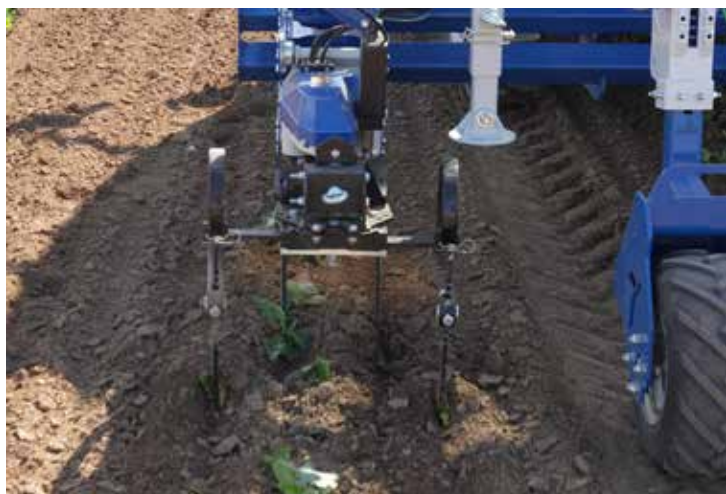
In-Row-Hacktechnik: Geräte, die dank Künstlicher Intelligenz (KI) und Kameras die Nutzpflanze direkt in der Reihe (In-Row) erkennen und dort mechanisch das Unkraut entfernen.
