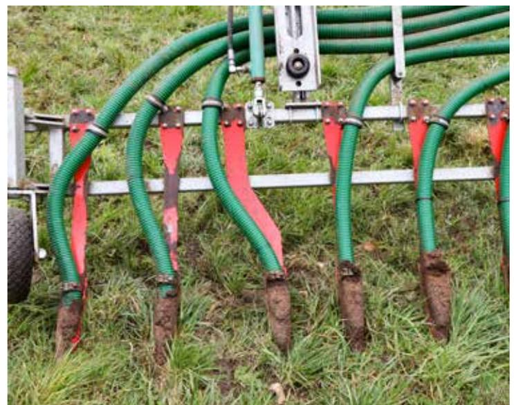
Der Schleppschuh legt das Substrat zuverlässig direkt am Boden ab. Das verringert die Futtermittelverschmutzung deutlich.
