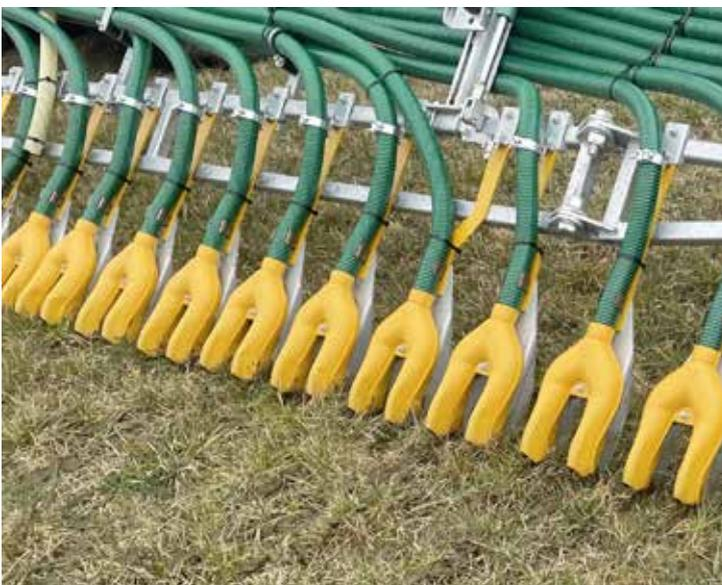
Mit Hilfe der „Duplo-Düse“ werden die abgelegten Güllebänder schlanker und das Futter wird weniger verschmutzt.
